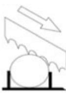
Überprüfen Sie den Füllstand des Behälters. Erhöhen Sie die Fließgeschwindigkeit des Kühlmittels und stellen Sie sicher, dass Öffnung und Auslassrohr nicht verstopft sind. Überprüfen Sie die Anteile der Emulsionsbestandteile.
